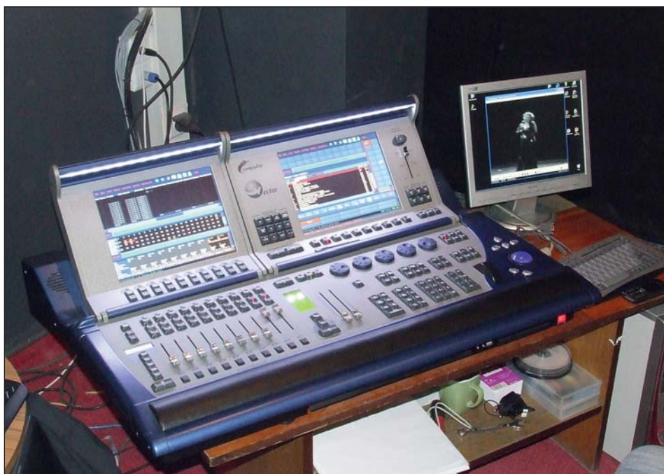
System oświetlenia scenicznego wykorzystuje konsolę Compulite Vector Blue.
